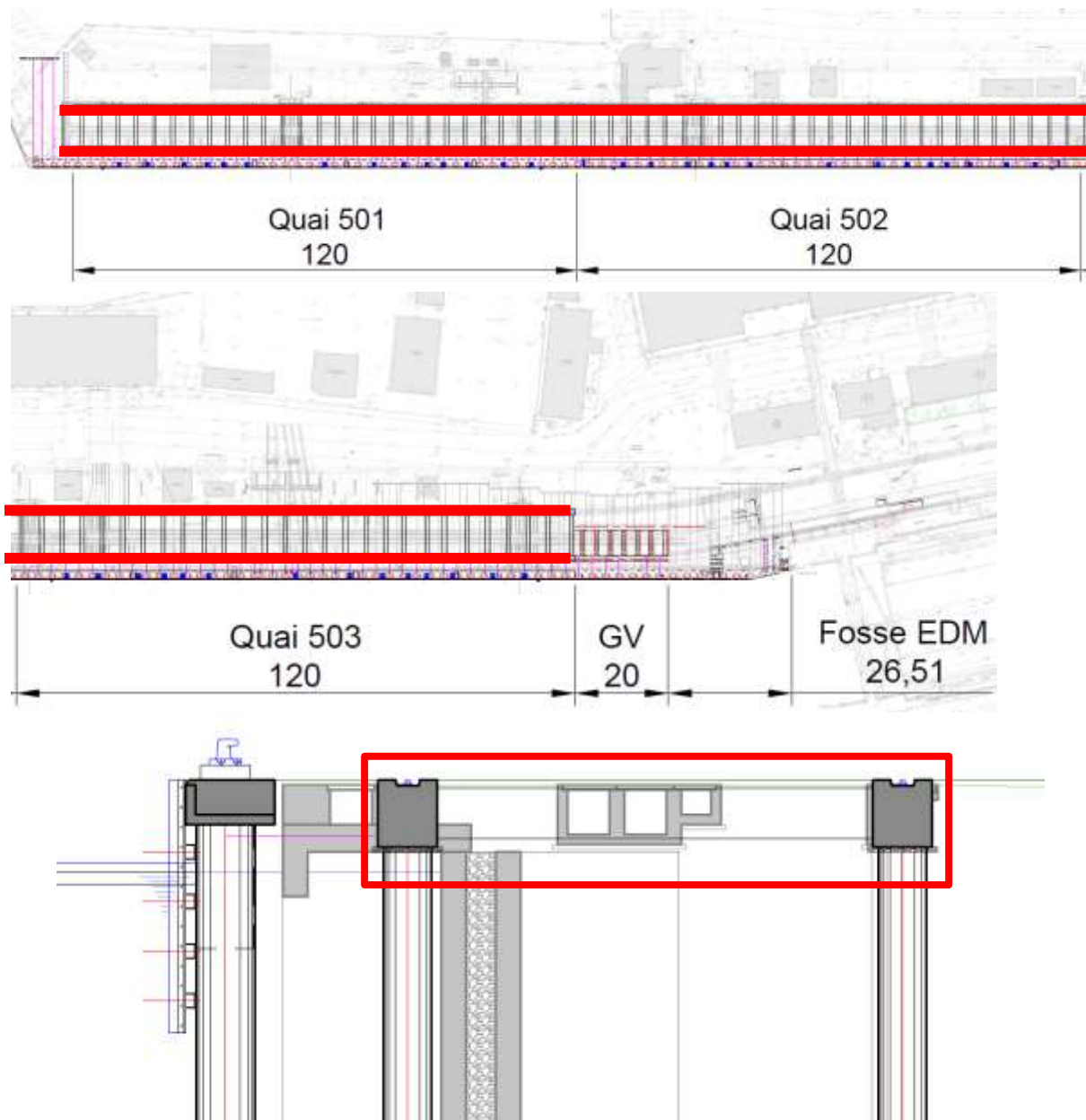
Figure 8. Emplacement de la voie de grue.
